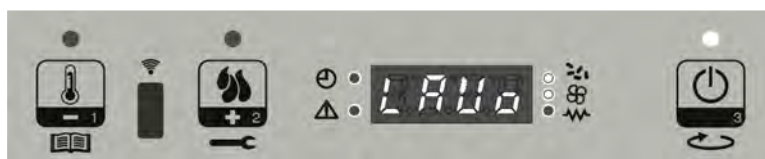
Visualizzazione messaggio che scorre sul display: LAVORO - ON5 - 22.5c
