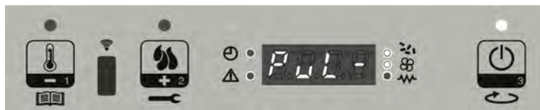
Visualizzazione messaggio che scorre sul display: PUL-BRACIERE
