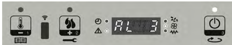
Visualizzazione messaggio che scorre sul display: AL 3 ALAR AL 3 HOT FUMI
