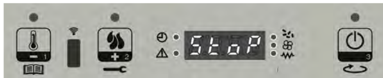
Visualizzazione messaggio che scorre sul display: STOP ECO TEMP GOOD
