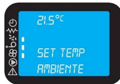
Quando la temperatura ambiente ha raggiunto il valore impostato, la potenza dell'apparecchio si porta automaticamente al valore minimo. In tali condizioni il display visualizza il messaggio [LAVORO MODULA].
