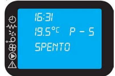
**i** In caso di prima accensione o dopo un episodio di allarme per mancanza di pellet: si ricorda che la coclea per l'alimentazione del combustibile è vuota, pertanto è necessario un tempo adeguato per il suo riempimento e per l'alimentazione del bruciatore; per effettuare ciò utilizzare la funzione [CARICO INIZIALE] del menù.
