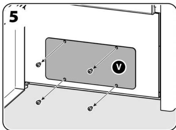
6. Togliere il coperchio vano raccolta polveri scambiatore [V] prestando attenzione a mantenere la guarnizione di tenuta.
