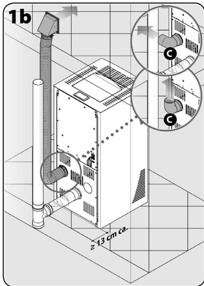
**!** Curva [C] obbligatoria da installare sulla canalizzazione se non utilizzata.
