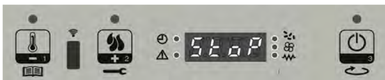
Visualizzazione messaggio che scorre sul display: STOP ECO TEMP GOOD
