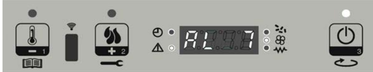
Visualizzazione messaggio che scorre sul display: AL 7 ALAR AL 7 SICUREZZA TERMICA
