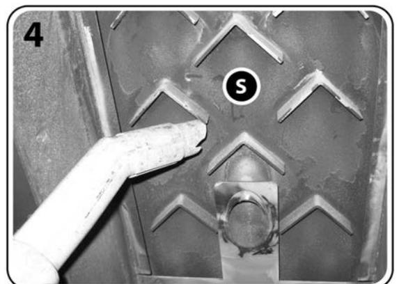
5. Svitare e togliere le 4 viti, che fissano il coperchio vano raccolta polveri scambiatore [V].
