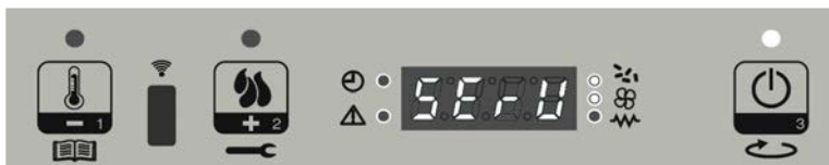
Visualizzazione messaggio che scorre (ogni minuto per la durata di 10 secondi) sul display: SERVICE
