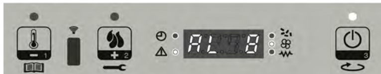
Visualizzazione messaggio che scorre sul display: AL 8 ALAR AL 8 MANCA DEPRESS-
