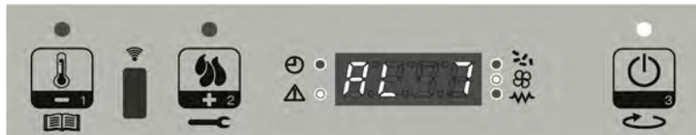
Visualizzazione messaggio che scorre sul display: AL 7 ALAR AL 7 SICUREZ-TERMICA
