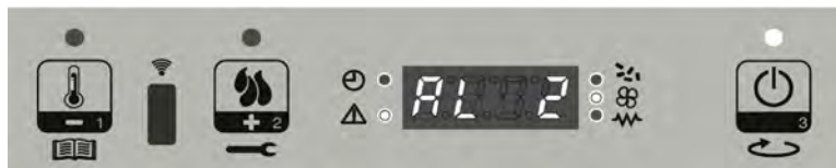
Visualizzazione messaggio che scorre sul display: AL 2 ALAR AL 2 SONDA FUMI
