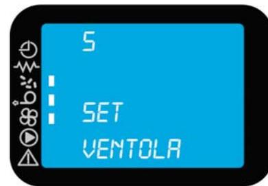
**ATTENZIONE: Il ventilatore funzionerà esclusivamente se la temperatura dell'acqua è sufficientemente calda da garantire un minimo di afflusso di aria calda.**
